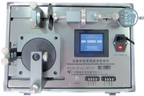
DX-01A设备状态监控系统校验仪是DX-01升级版,使用液晶触摸屏,取消面板按键,重置接口及端子,使面板布局更为简洁、操作更为智能及方便。同时优化部件,改进程序,使仪器的精度及稳定性大为提升,无愧于市场上最多功能、智能化及高精度的设备状态监控系统校验仪的称号!
